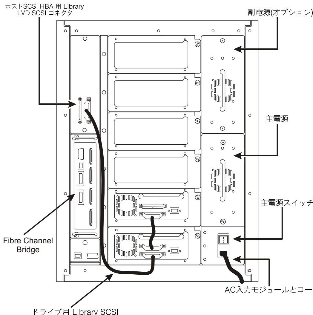
12 背面パネルの主電源スイッチを押して、ONにします。
