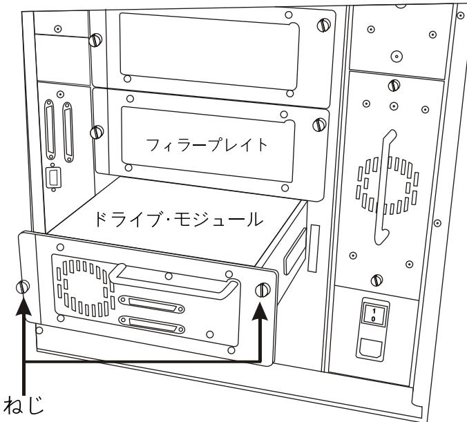
4 次に、ドライブ・モジュール同士を接続します。ジャンパーケーブルの一方を、一番下のドライブのSCSIコネクタ(最上部)に差し込んでください。さらに、ケーブルのもう一方を、一番上のドライブのSCSIコネクタ(最下部)に差し込みます。
