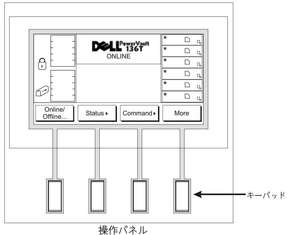
LCD ディスプレイ: 操作パネルのLCD は、左端・中央上・右端・中央下の4つに分かれています。
